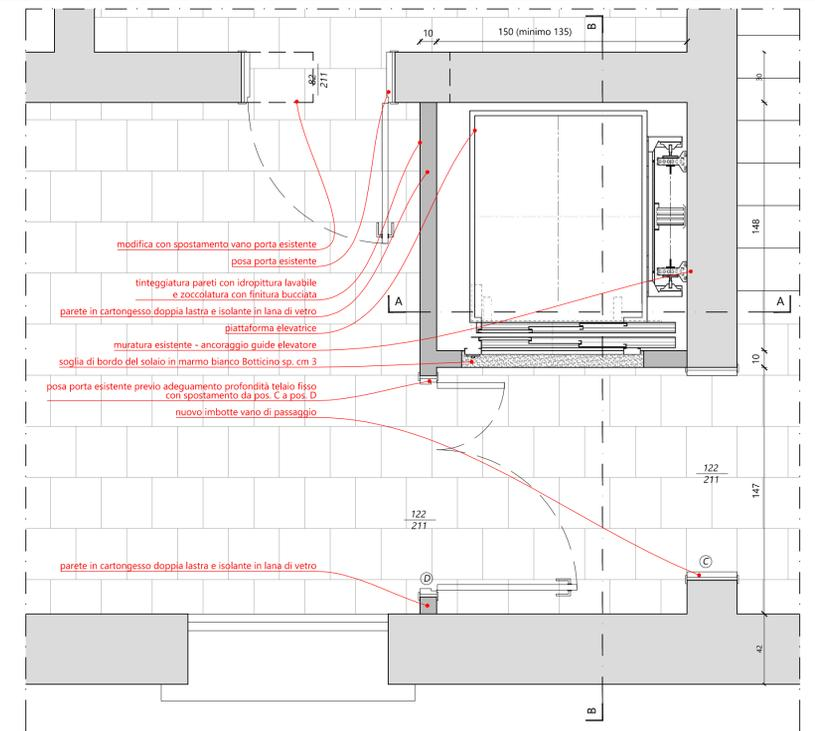
PIANTA PIANO PRIMO VANO CORSA - Scala 1:20
