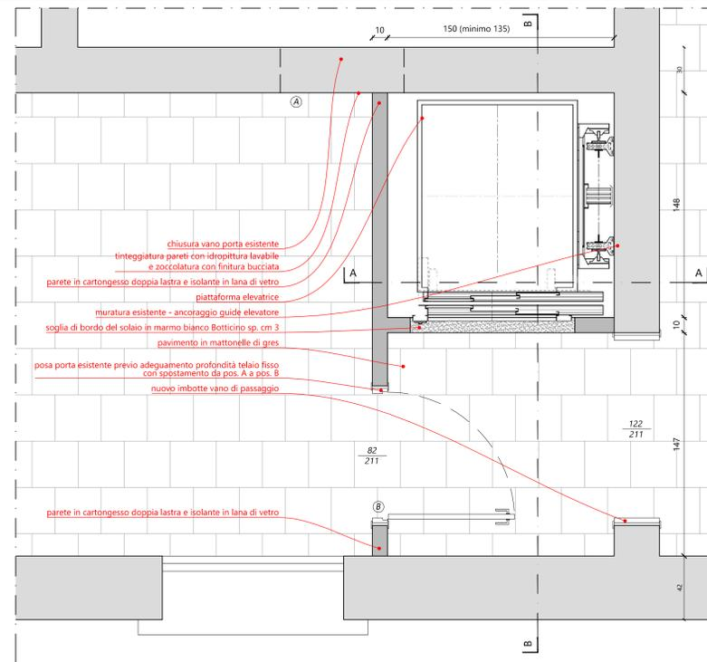
PIANTA PIANO TERRA VANO CORSA - Scala 1:20
