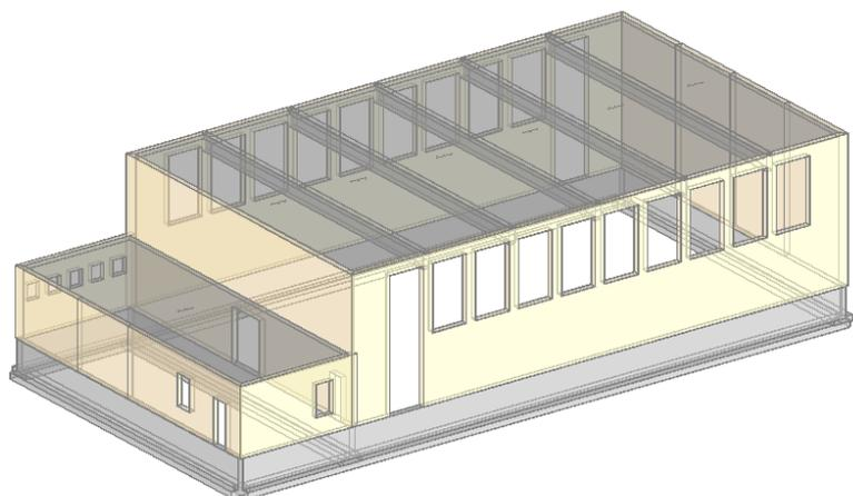
Nel complesso la struttura non può definirsi regolare né in pianta né in altezza, con forti variazioni di rigidità dovuti alla differenti altezze dei maschi resistenti e alla presenza delle numerose forometrie in elevazione.
