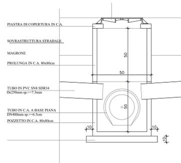
Sezione Tipica dello Scavo Cadoitoia
