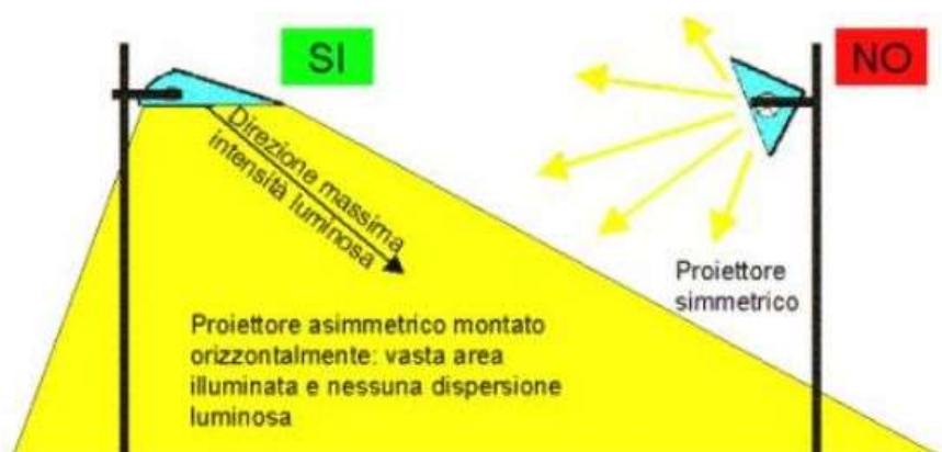
Figura 32 Proiettore installato in modo conforme alla L.R. 17/09
