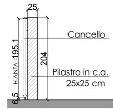
**SEZIONE PARAPETTO MANCORRENTE** - scala 1:20
