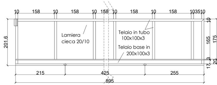
Cancello carraio scorrevole in ferro zincato delle dimensioni ca 850x200 cm, più coda per fermocorsa, realizzato con profilo tubolare a sez. rettangolare con base da 200x100x3 mm, terminale e profili tubolari quadrati interposti da 100x100x3 mm e da pannelli in lamiera cieca 20/10, completo di serratura/chiave maniglia e guida di scorrimento.
