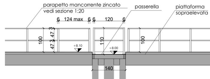
**DETTAGLIO PARAPETTO IN GRIGLIATO ELETTROSALDATO** - scala 1:50
