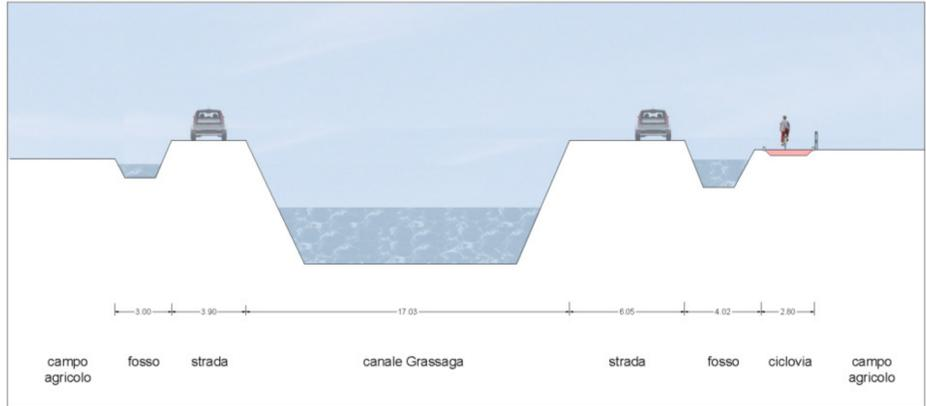
SEZIONE 2 - Stato di progetto scala 1:200
