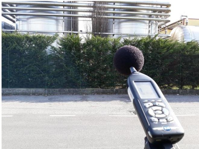
**Figura 14.** Postazione di misura E bordo strada per la verifica del limite assoluto di immissione.
