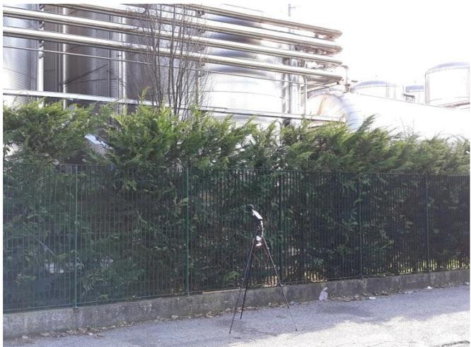
**Figura 13.** Postazione di misura D bordo strada per la verifica del limite di emissione.
