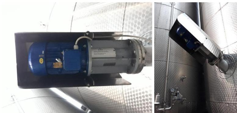
Figura 6. Agitatori delle autoclavi da 120.000 litri
