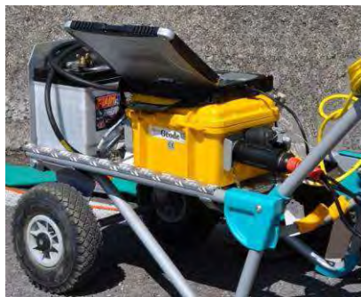
Figura 7 - Strumentazione per la misura della VS. Sismografo a 24 canali Geometrics GEODE (a sinistra). Schema di accoppiamento dei geofoni su pavimentazione (al centro) o su strada sterrata o in ghiaia (a destra).
