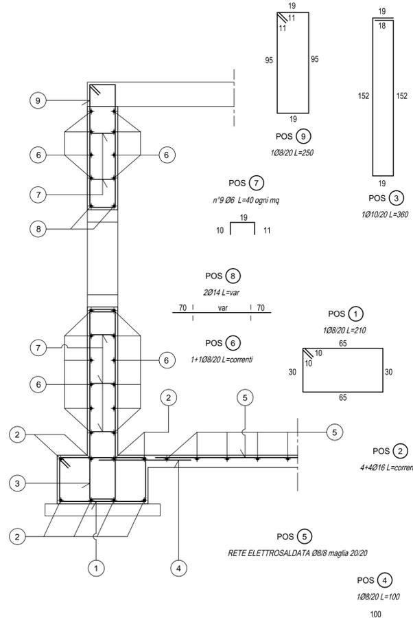
Armatura muro - Sezione 1
