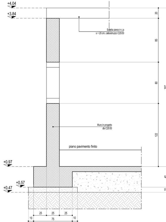
Carpenteria muro - Sezione 1
