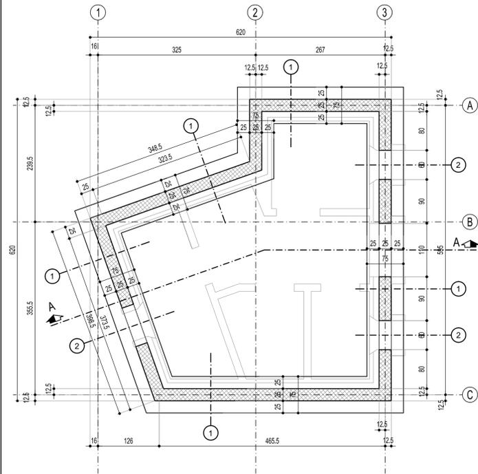
Carpenteria muro - Sezione 2
