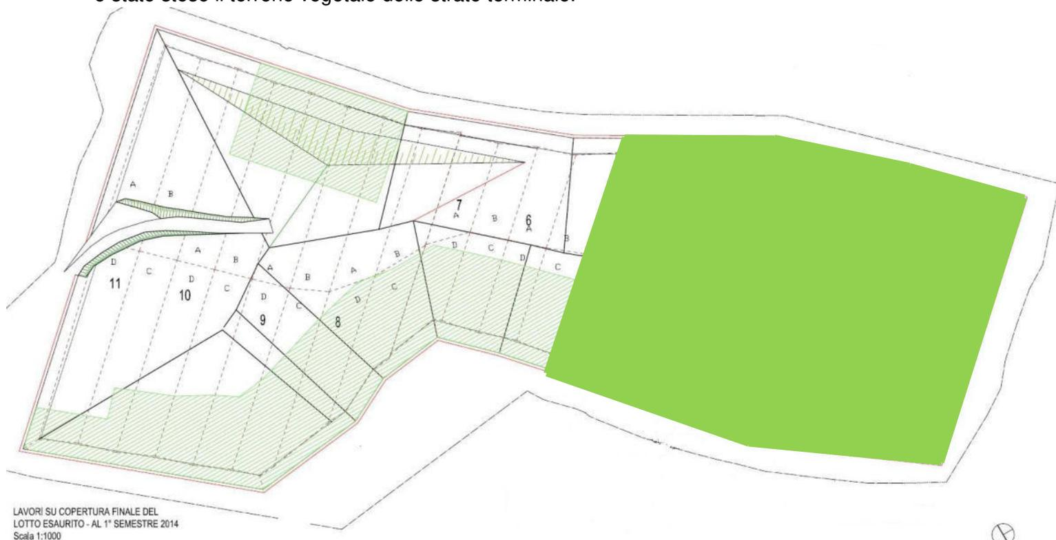
Fig. 7-7 Planimetria stato avanzamento lavori di copertura finale
