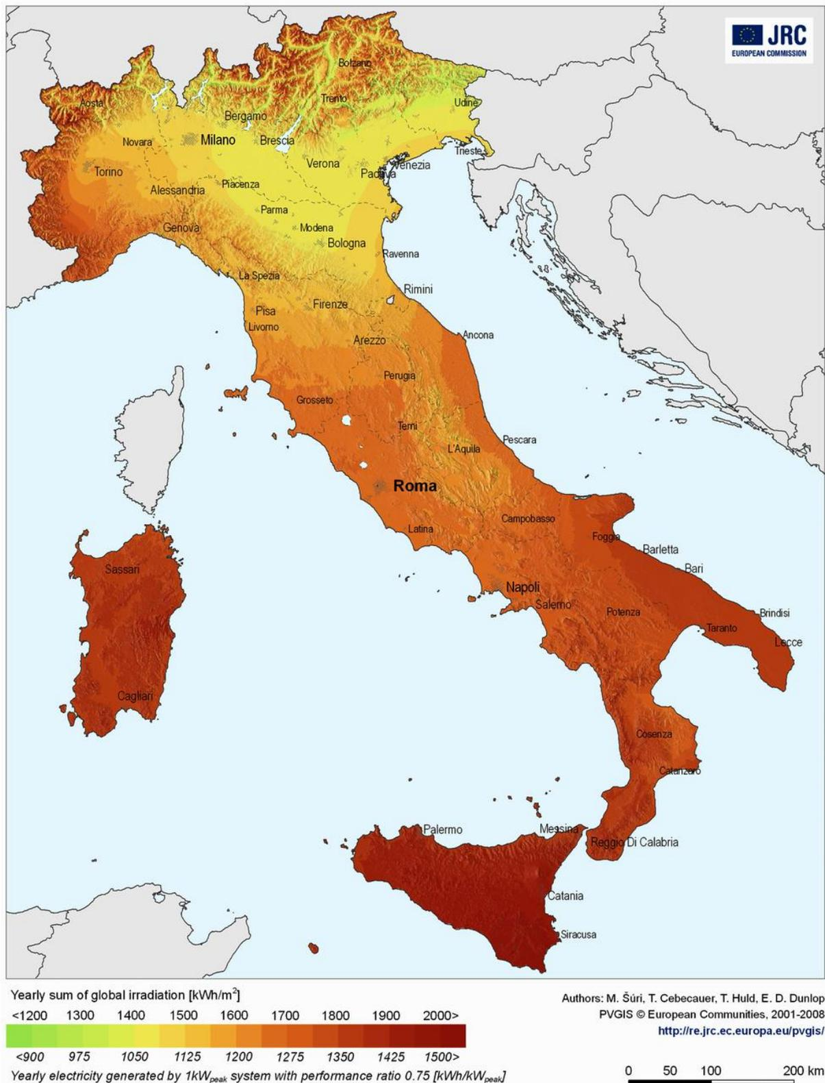
Figura 38. Energia generata da 1 kWp di fotovoltaico con inclinazione ottimale in Italia.
