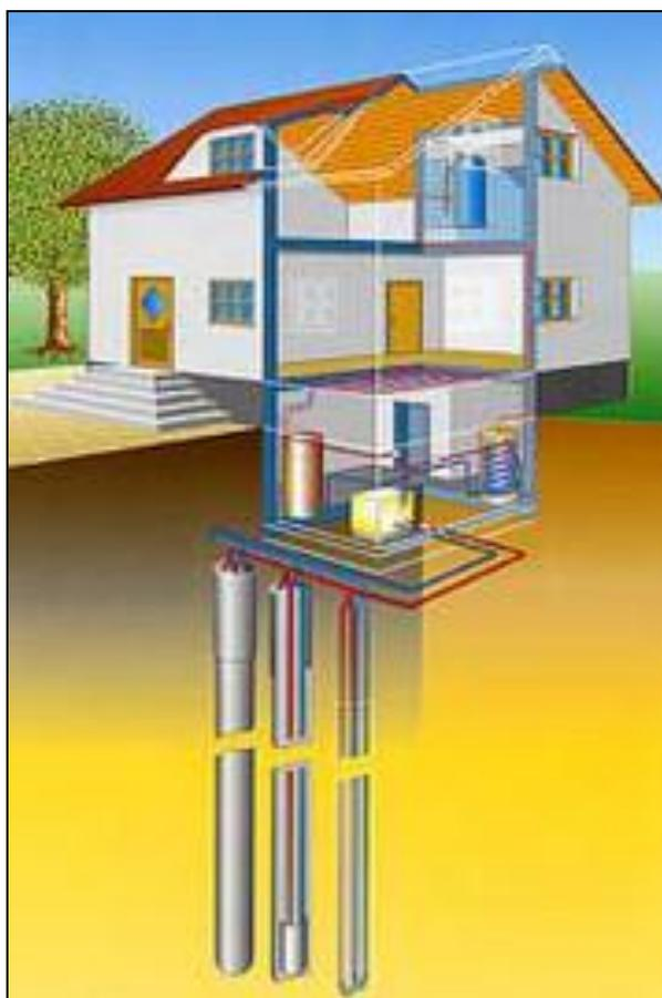
**Figura 46. Schema di un impianto geotermico a bassa entalpia con le relative sonde geotermiche.**
