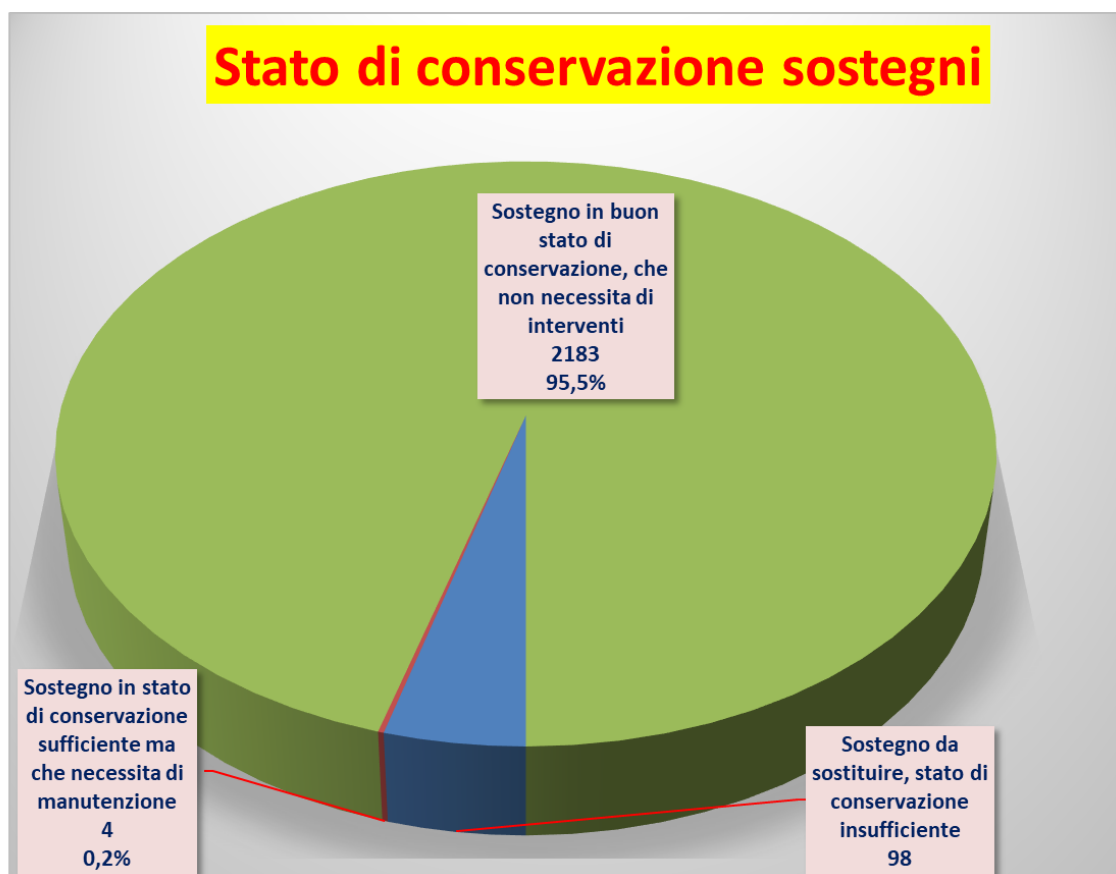
Figura 12 – Sostegni suddivisi per stato di conservazione
