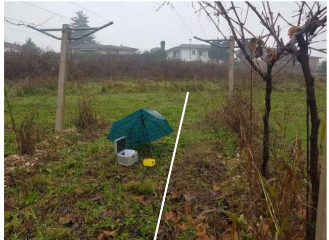
Misura Sismica Re.Mi.
