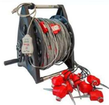
verticale a 4,5 Hz per la necessità di analizzare con elevato dettaglio le basse frequenze.
