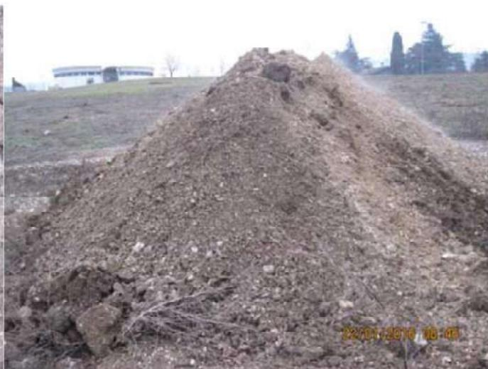
I terreni dell'area, al di sotto del vegetale, sono costituiti da alternanze di livelli a ghiaie ed argille prevalenti, con grani con spigoli prevalentemente non arrotondati e forme irregolari, indice di scarso trasporto.
