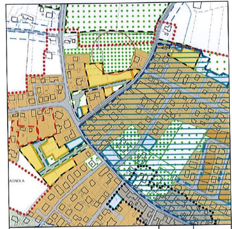
ZONIZZAZIONE NORD PERICOLOSITA' IDRAULICA SCALA 1.5000
