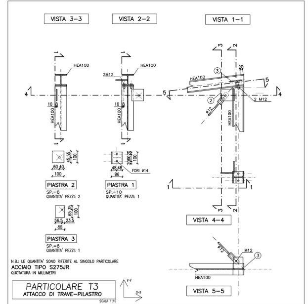
**PARTICOLARE T3 ATTACCO DI TRAVE-PILASTRO**
