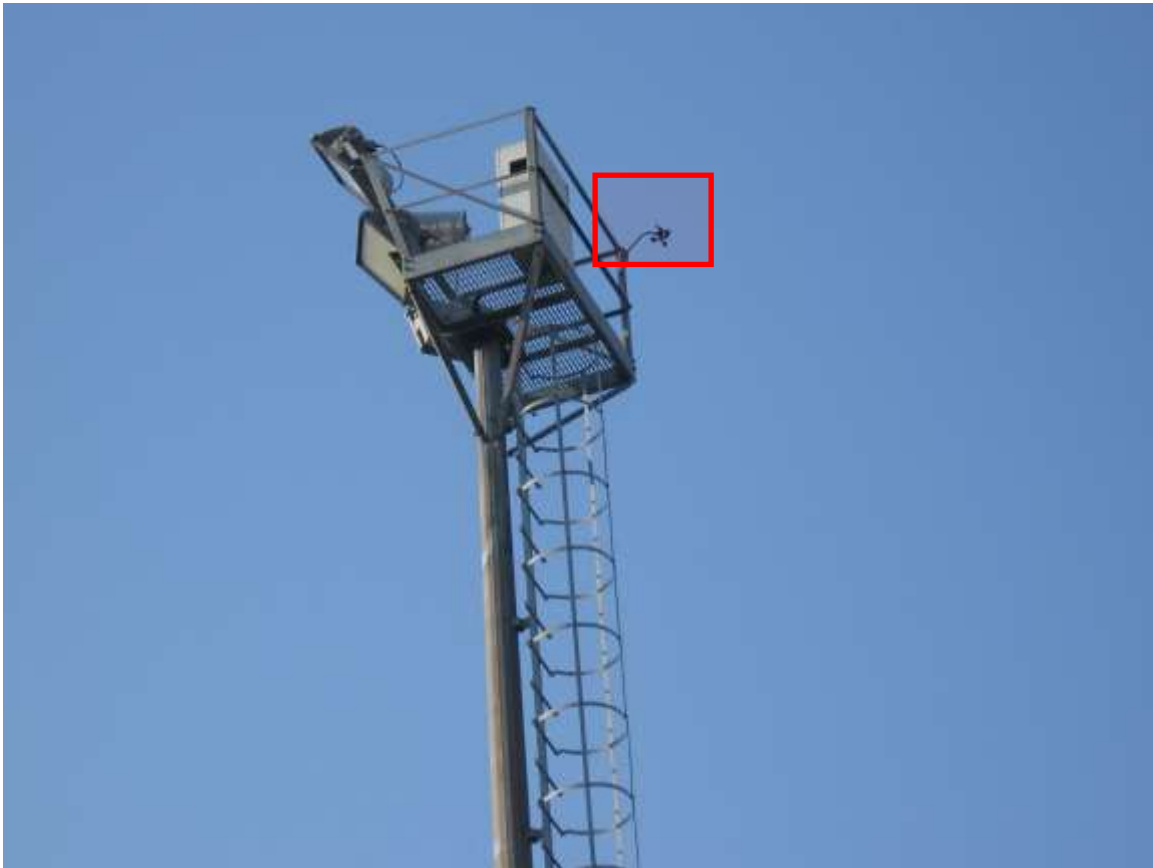
Figura 58. Ingrandimento dell'anemometro installato sulla torre faro del campo da calcio di Lerino.
