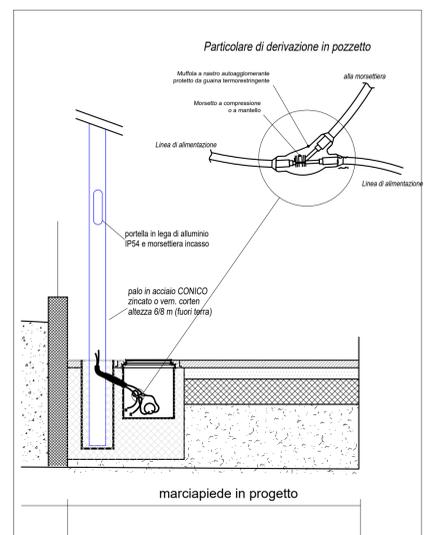
PARTICOLARE INSTALLAZIONE PALO E DERIVAZIONE IN POZZETTO fuori scala
