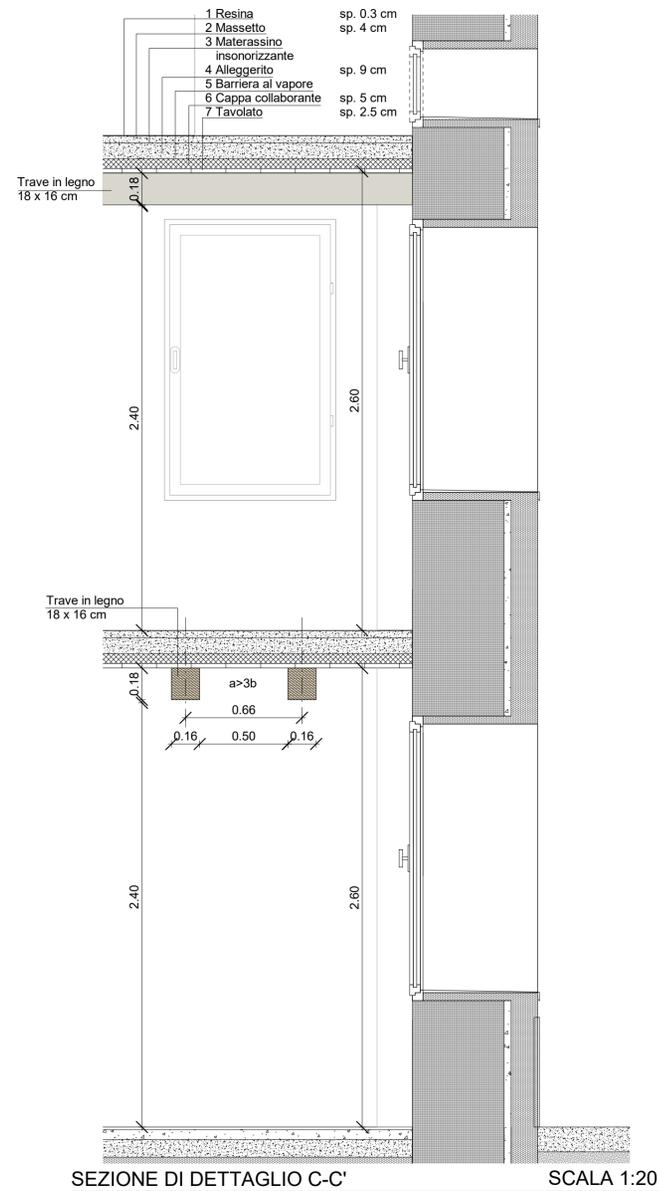
SEZIONE DI DETTAGLIO C-C'
