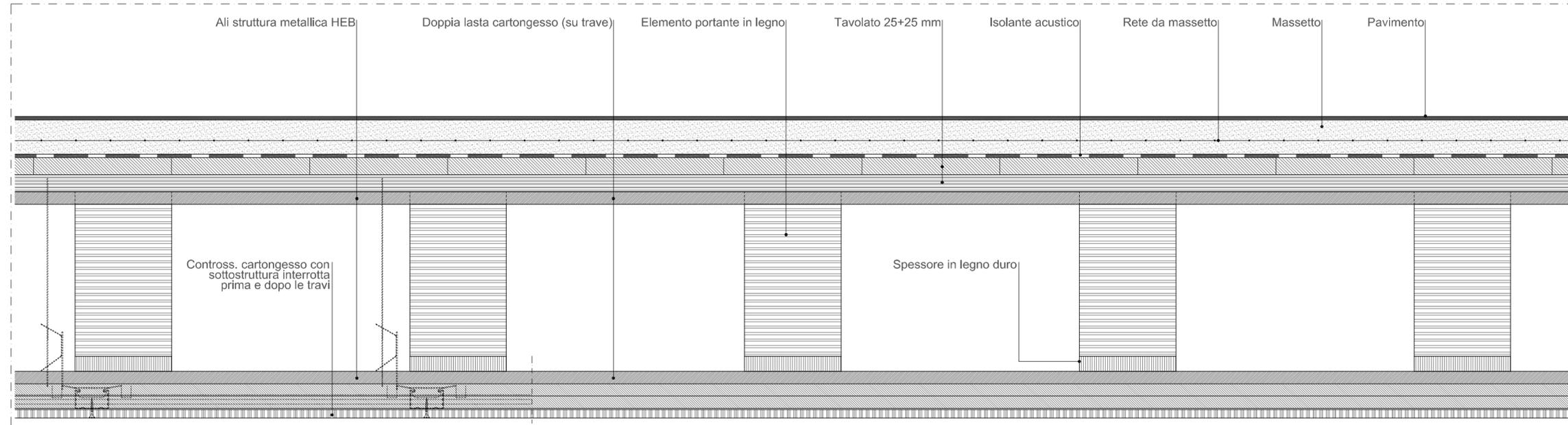
SEZIONE TIPO SOLAI PIANO PRIMO - scala 1:5
