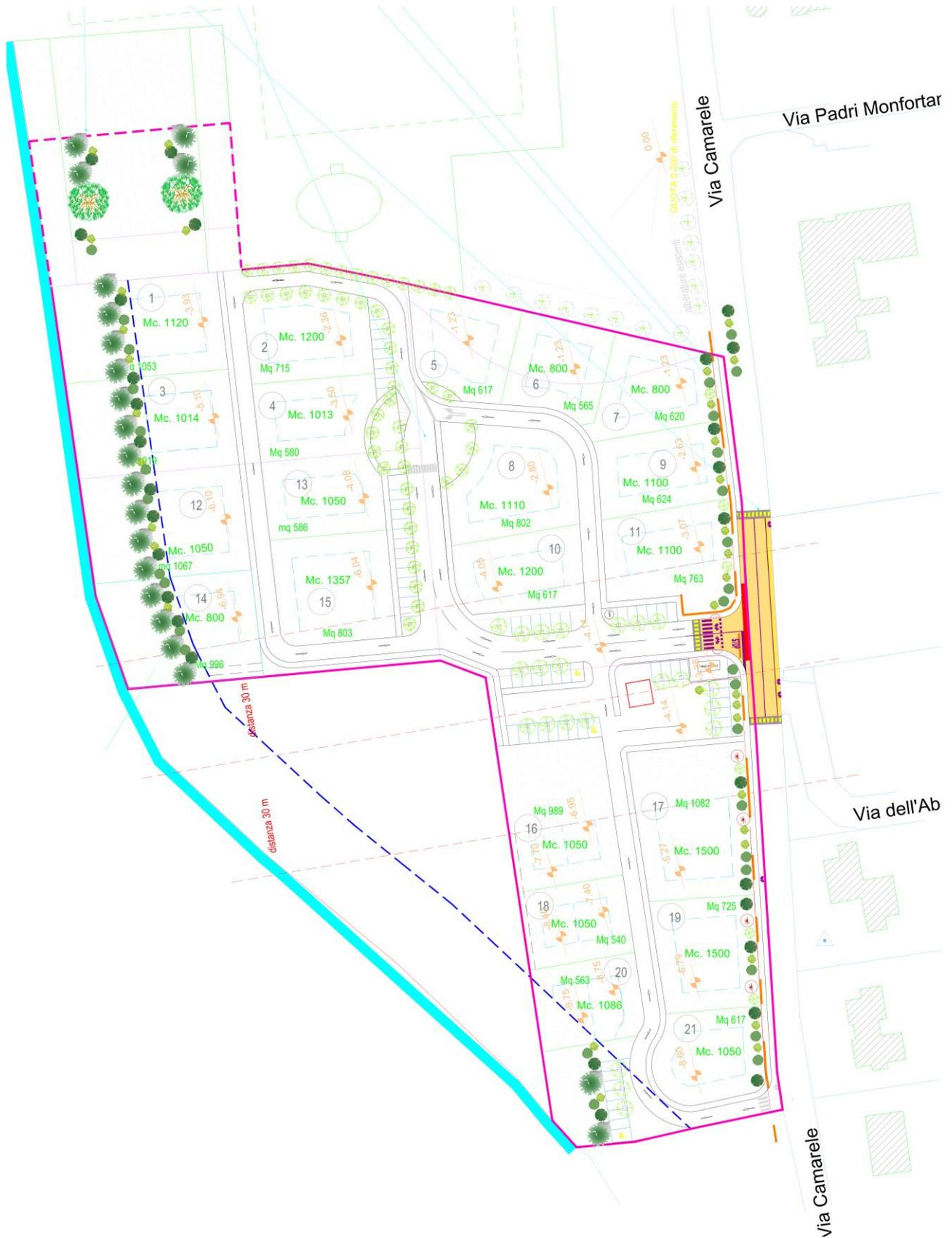
Figura 3 Planimetria di progetto con identificazione dei lotti
